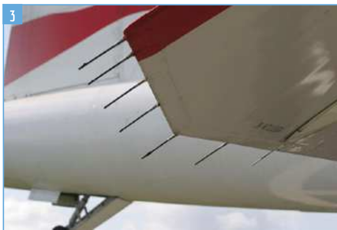
Figura 3. Descargadores de energía estática
