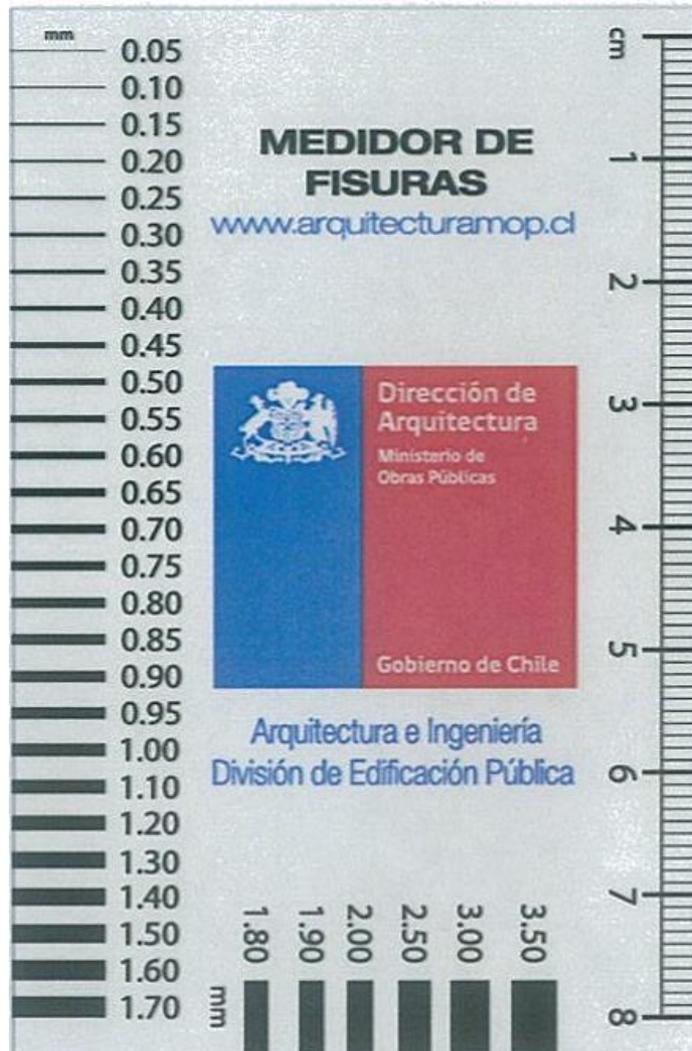
Es útil contar con una herramienta de medición que permita poder verificar el espesor de fisura (o grieta)
