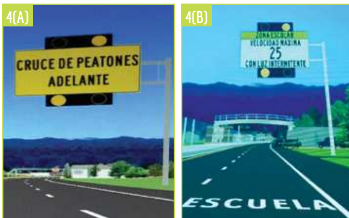
Figura 4 Dispositivo de control de tránsito propuesto para la Escuela Franklin D. Roosevelt (a) y S.U. Samuel Adams (b)
