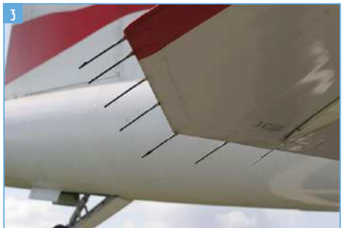
Figura 3. Descargadores de energía estática
