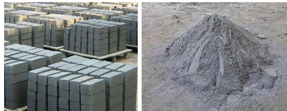
La aplicación de las **Cenizas** tanto en Hormigones como en la fabricación de Ladrillos es adecuado ya que se consigue abaratar el material de la construcción (una cantidad de cemento se sustituye por cenizas), sin perder la calidad del producto, produciendo un material sostenible desde el punto vista medioambiental.
