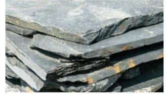
Las **rocas metamórficas** (del griego meta, cambio, y morphe, forma, “cambio de forma”) resultan de la transformación de rocas preexistentes que han sufrido ajustes estructurales y mineralógicos bajo ciertas condiciones físicas o químicas, o una combinación de ambas, como son la temperatura, la presión y/o la actividad química de los fluidos
