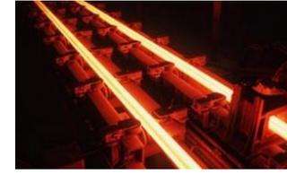
**Perfiles metálicos**, son productos laminados, fabricados usualmente para su empleo en estructuras de edificación, o de obra civil. (Laminación, laminado o rolado) se conoce al proceso industrial por medio del cual se reduce el espesor de una lámina de metal).
