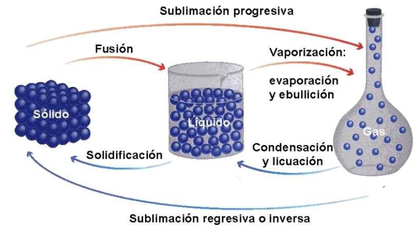
Los **cambios de fase** son fenómenos físicos reversibles y se producen a una temperatura constante la cual depende de la naturaleza de la sustancia. Por ejemplo el agua pasa de sólido a líquido a 0 °C y de líquido a vapor a 100 °C.
