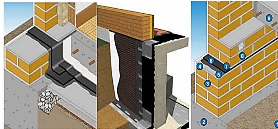
Soluciones de Impermeabilización de elementos en contacto con el terreno con láminas bituminosas
