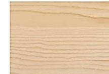
Madera ligera y blanda, comparable con el pino. Peso relativamente bajo con buena resistencia y elasticidad. Fácil de trabajar en todos los aspectos. Relativamente a los químicos es mucho más resistente de que la mayoría de las maderas. Libre de resinas. Se utiliza mucho en la construcción de revestimientos de pared y techo para el interior.
