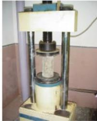
Objeto ensayo: rotura de probetas cilíndricas de hormigón a sollicitación de compresión.
