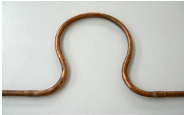
**Lira de dilatación:** Pieza con forma de herradura que se utiliza en las tuberías para soportar las dilataciones y contracciones que se producen por los efectos de la temperatura
