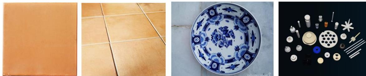
• Dependiendo de la temperatura de cocción se obtienen distintos tipos de cerámicas con diferente absorción:
