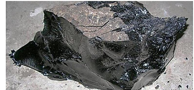
El Betún es la mezcla de hidrocarburos naturales o de petróleo, sólidos, viscosos o líquidos, conteniendo una pequeña proporción de productos volátiles; tiene propiedades aglomerantes es completamente soluble en el sulfuro de carbono. Se caracteriza por tener muy buena penetración, elasticidad y flexibilidad.
