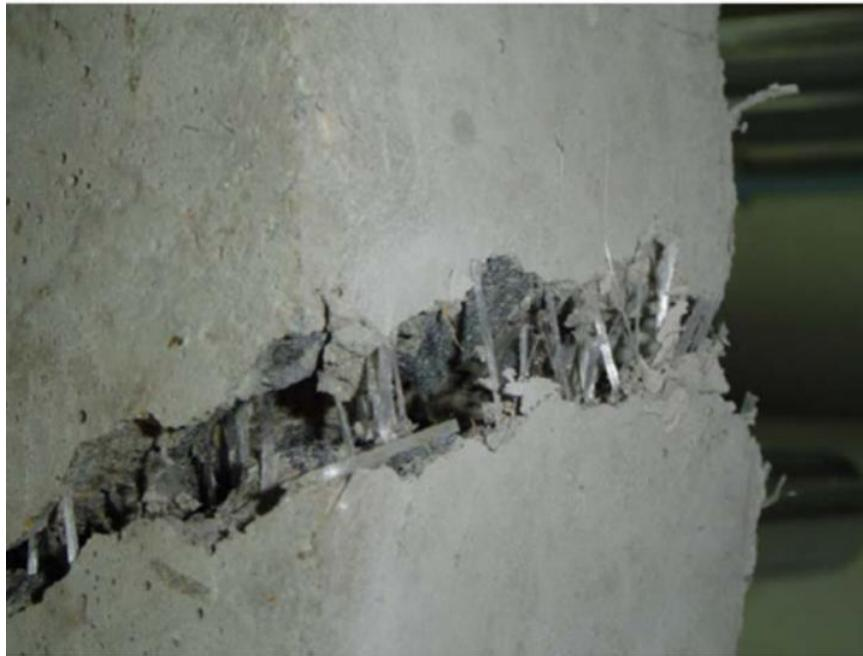
Imagen de la fisura una vez finalizado el ensayo de carga estática de flexión a 3 puntos de una probeta prismática de 40 x 10 x 10 cm de FRC 0,8% PP. 40 mm
