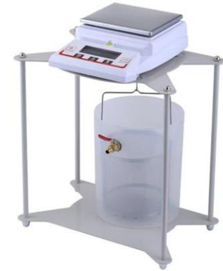
Ensayos de balanza hidrostática
