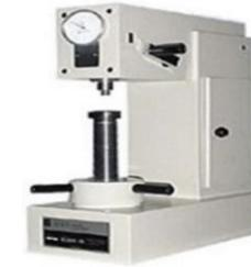
Para para medir la dureza de los materiales, se utiliza una máquina calibrada llamada durómetro
