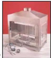
Equipo de ensayo de Reacción al fuego
