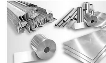
**Aceros inoxidables:** Contienen **Cr** (cromo), **Ni** (níquel) u otros elementos en aleación que aumentan la resistencia a la oxidación.
