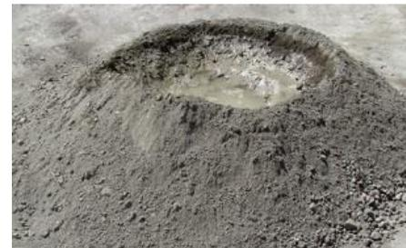
El **Hormigón**, es una mezcla de áridos, cemento, aditivos y agua. El hormigón es el material de construcción más común y más utilizado. Puede utilizarse solo o armado.
