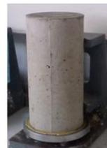
Refrentado de probeta cilíndrica
