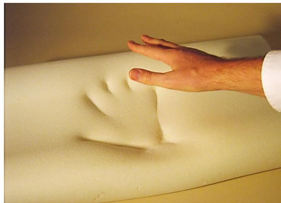
Espuma viscoelástica, es un sólido deformable ya que tiende a recuperar su forma para esfuerzos ligeros, aunque el modo de recuperación es retardado a diferencia de un sólido elástico en que la respuesta es prácticamente instantánea
