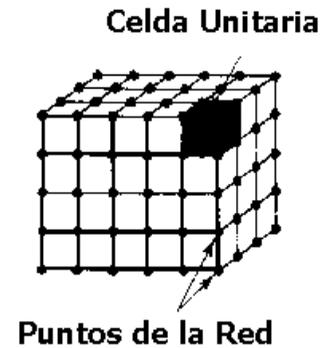
La estructura del sólido cristalino se representa mediante la repetición de la celda unidad en las tres direcciones del espacio
