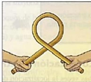
**Ductilidad.** Es la capacidad que tiene un material para estirarse en hilos. (ej.: cobre, oro, aluminio, etc.)
