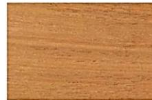
El cedro es una **madera blanda** de color rojizo, muy conocida por su olor dulce. El cedro es ampliamente utilizado en cajoneras, cubiertas y tejas. Se usa mucho en la construcción, para forrar muebles, etc.
