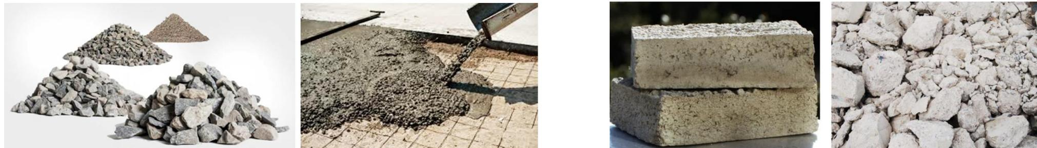
**residuos de demolición/construcción** (áridos reciclados, pesados y ligeros),
