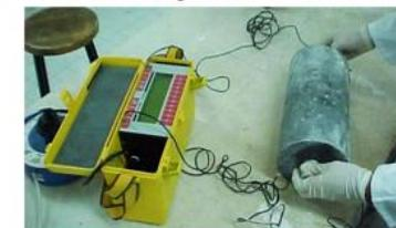
Ensayo de rigidez de un hormigón por ultrasonidos
