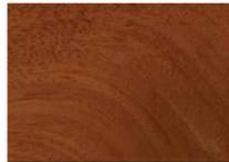
Esta madera de grano fino muy resistente tiene un hermoso color marrón rojizo. Es una de las preferidas en ebanistería ya que en gran parte se emplean para muebles de calidad, como armarios, revestimientos de madera y chapas. Debido a su propiedad de alta densidad y durabilidad es muy empleado en zonas tropicales que tienen alta humedad.
