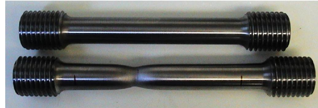
Ensayo de tracción. Probeta antes y después de la rotura
