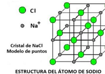
Esta **sustancia sólida** resultante es **dura**; tiene **punto de fusión** de aproximadamente **800°C**. La gran **fuerza de enlace** en el **cloruro de sodio** se debe a las **atracciones entre iones de carga opuesta** que se encuentran muy cercanos entre sí.
