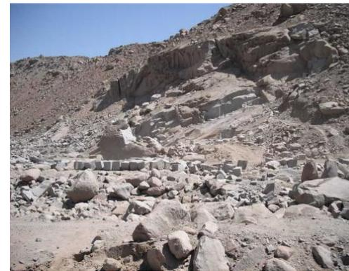
**Granito**, también conocido como **piedra berroqueña**, es una roca ígnea plutónica constituida esencialmente por minerales como cuarzo, feldespato y mica. Se usa principalmente en suelos (en forma de losas), revestimientos y encimeras.
