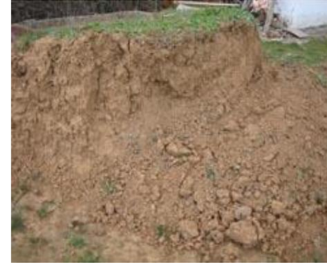
**Barro** o lodo es una mezcla semilíquida de agua y tierra compuesta por sedimentos, partículas de polvo y arcilla. compactado "in situ" produce tapial (construir muros con tierra arcillosa húmeda)
