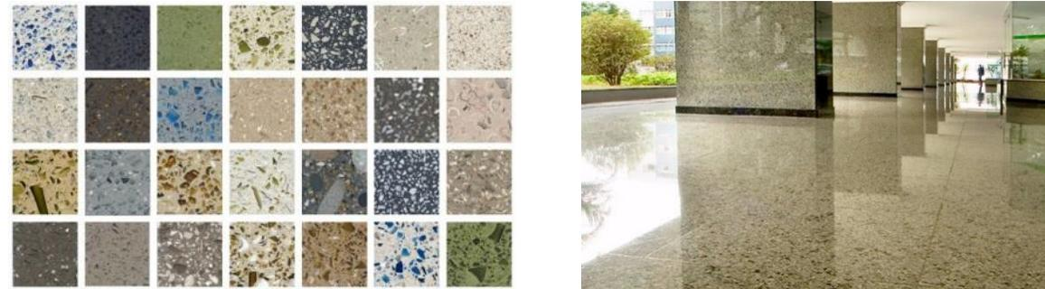
**Piedra artificial**, es un material de construcción de cemento refinado fabricada para simular la piedra tallada natural. Son piezas prefabricadas con cemento y diversos tipos de piedra.
