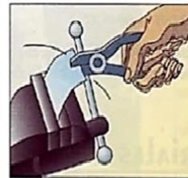
**Fatiga.** Deformación (que puede llegar a la rotura) de un material sometido a cargas variables. Inferiores a la rotura, cuando actúan un cierto tiempo o un cierto número de veces.
